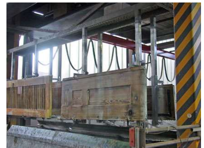
Foto III: Fensterläden im Ablaugevorgang
